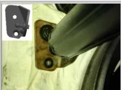
2.4 安装左下支架：把左下支架装上，用内六角沉头螺钉 M6 20 拧紧，如图已安装好，支架区分左右安装，支架箭头朝车前
