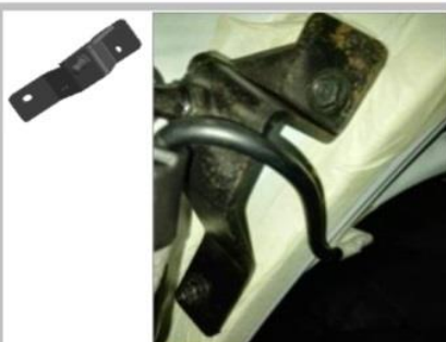
2.5 安装左上支架：把左上支架如图装上，用原车螺钉还原安装，支架箭头朝上
