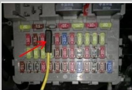
3.21 接解码器正极线 ：如图箭头一处正确安装取电；注意：如图对应位置正极插入，若反插将导致尾门无法使用
