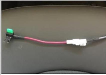
3.25 接 ECU 正极 如图示意接正极取电器, 用我司正极插头插进原车保险盒内 (中高配 ECU 正极取电)
