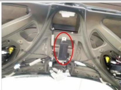
3.5 安装 ECU：ECU 安装在尾门盖板上门锁圆圈处位置，用支架配合底板夹紧原车钣金，固定好，防止松动脱落（利用门上椭圆孔）
