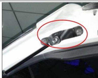
2.2 用一字螺丝刀把原车左、右侧撑杆头翘起、拆下
