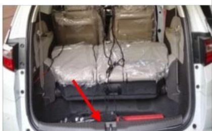
1.1 拆卸后踏盖：首先把原车后踏盖拆下，再把原车落锁扣取下
