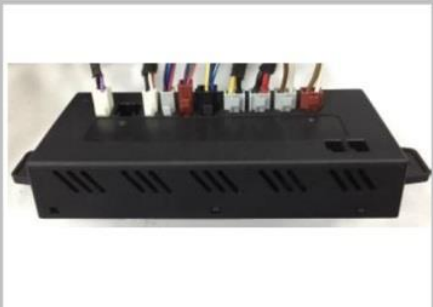
3.4 连接 ECU，待所有线束插好，最后插电源线插头（插头如前面 ECU 插头说明示意大图）
