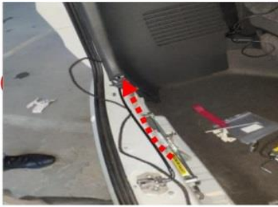
1.7 驱动盒以及拉线布置完成，如图所示，注意：内饰板等对插线后再还原
