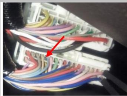
3.16 接控制信号线 ：拆下左后边的盖板后可以看到我们要接信号线的位置（倒车雷达模块），图所示，然后剥开波纹管，找到线束
