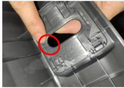
1.8 将原车后盖板按图示标记位置割胶约 2mm 左右，具体割胶量以实配为准
