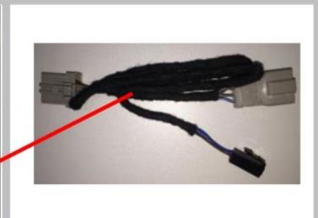
3.9 接门锁线：用我们配的转接线连接，再把我司转接线插头（箭头）插进上门锁，注意如图拍摄角度
