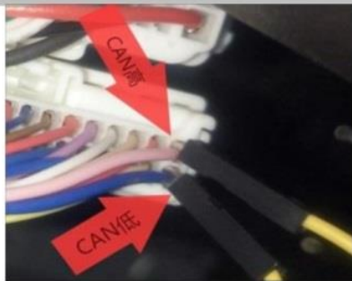
3.15 接解码器 CAN 信号 ：此处的粉色线为 CAN-H，接我们的绿色线，剥开此处粉色线，用我们的绿色线缠上，并用电工胶布包扎并固定好
