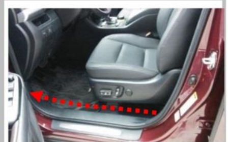
3.32 布置正极线: 拆卸原车驾驶室内侧装饰件线束隐藏在胶条内, 线束延伸到驾驶室中控台 (虚线)
