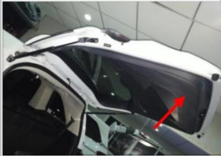
3.1 拆下车顶篷塑料装饰件（箭头）；ECU 上置，蜂鸣器、左右撑杆线、控制信号线上置
