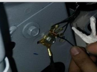
3.11 接 ECU 负极：（黑色线）在尾箱左侧内部此处搭铁
