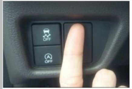
3.29 安装按钮开关: 然后开关按钮装上, 开关插头对插
