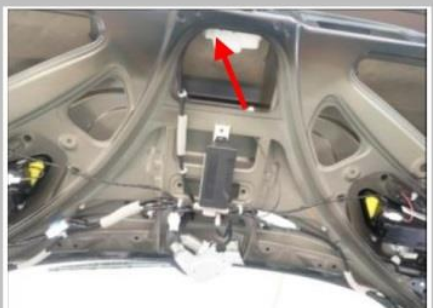
3.7 接门锁线：在尾门上方，箭头位置找到原车信号线插头，注意如图拍摄角度
