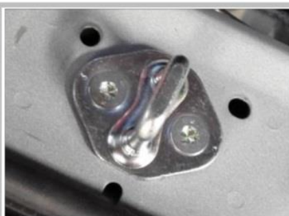
1.2 用套筒拆卸原车锁扣
