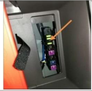
3.26 接 ECU 正极 用正极保险丝插入此原车从上往下数第 3 个空接口 (中高配 ECU 正极取电)
