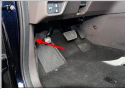
3.12 接解码器 CAN 信号 ：拆下左边装饰板，在内部找到我们要接的白色接头线束
