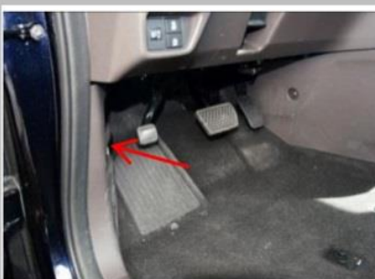
3.22 接解码器负极 ：在 A 柱内找到原车负极螺栓柱
