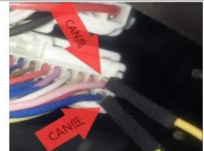
3.14 接解码器 CAN 信号 ：此处的蓝色线为 CAN-L，接我们的绿黑色线，剥开此处蓝色线，用我们的绿黑色线缠上，并用电工胶布包扎并固定好
