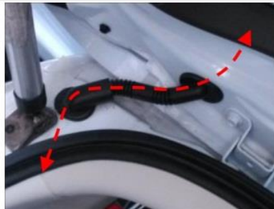
3.2 正极、负极线束穿过内侧，通过波纹管延伸到尾箱下
