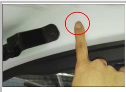
2.6 左撑杆穿线孔在此处位置打孔，左右两边穿线孔一致
