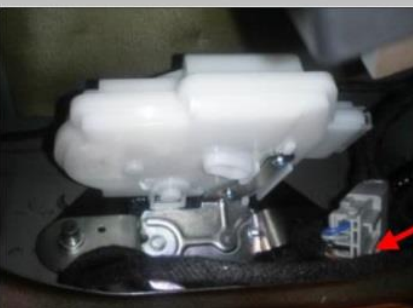
3.8 接门锁线：上门锁扣背后如图此位置拆下原车插头连接器，注意如图拍摄角度
