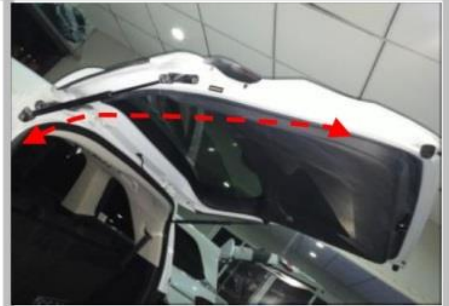
3.3 把正极、负极线穿过波纹管，延伸到尾箱左侧
