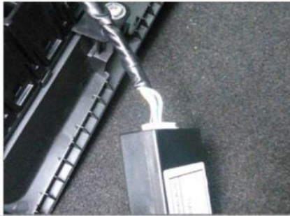
3.27 所有线束接好后把解码器装在驾驶室 A 柱内部位置并用魔术贴或 3M 胶固定好
