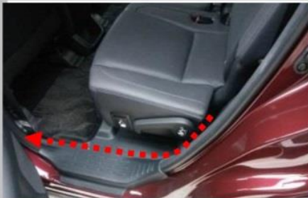
3.31 布置正极线: 拆卸左侧迎宾踏板胶条, 线束穿过后门迎宾踏板胶条 (虚线)
