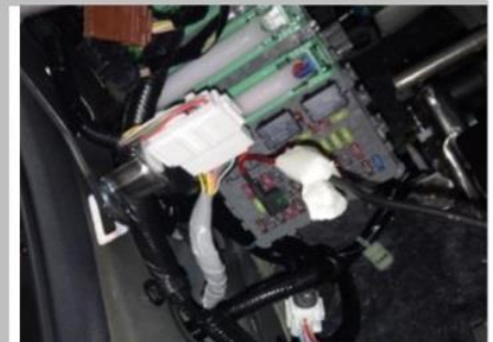
3.35 低配车正极接线: 如图箭头一处正确安装取电; 注意: 如图对应位置正极插入, 若反插将导致尾门无法使用
