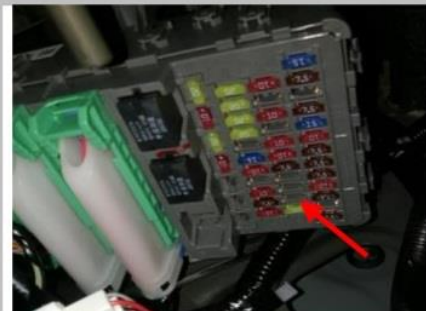
3.34 低配车正极接线: 找到此原车保险盒, 正确插入取电器取电
