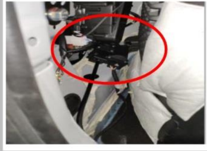
1.6 掰开尾箱左侧内饰板；将驱动盒伸到尾箱左侧空位处
